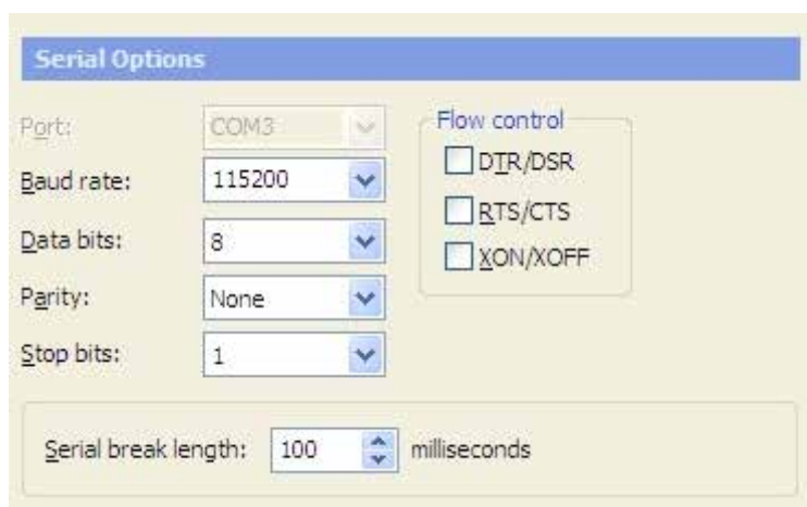
Figure 47 USR-WIFI232-S/T/G2/H default parameters
